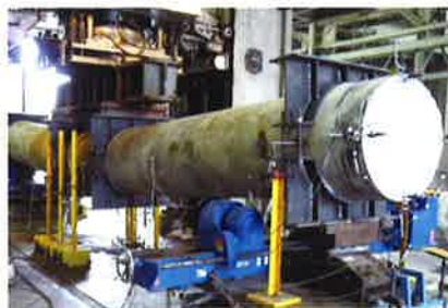
写真-2 本体部曲げ試験(載荷後)
