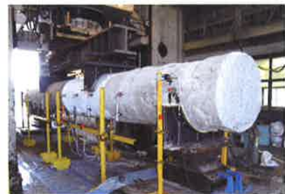
写真-3 継手部曲げ試験
