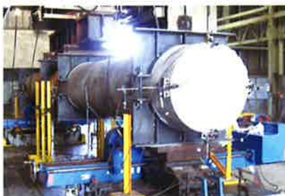
写真-1 本体部曲げ試験(載荷前)
