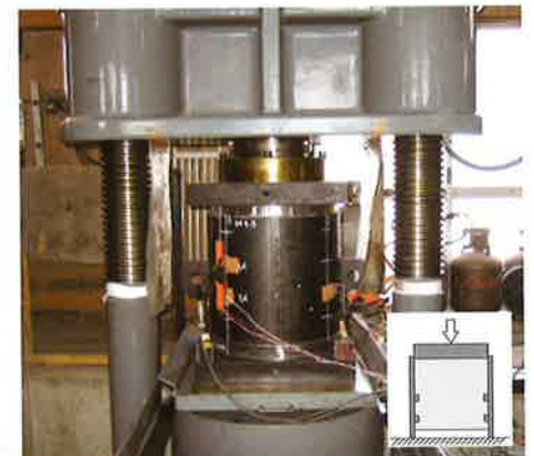
突起リングの押抜試験
