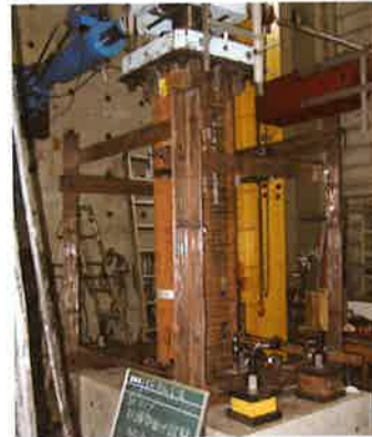
反力壁を用いた鋼管コンクリート部の曲げ試験
