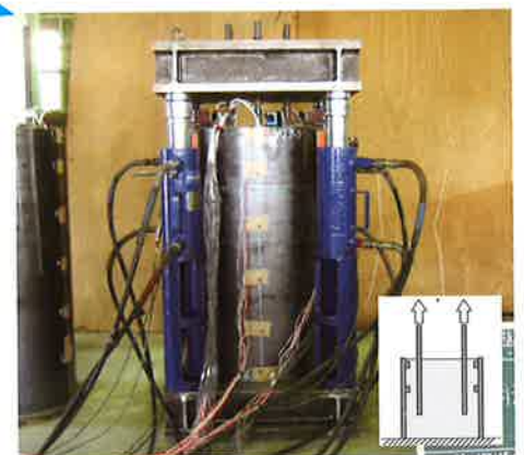
突起リングの引抜試験
