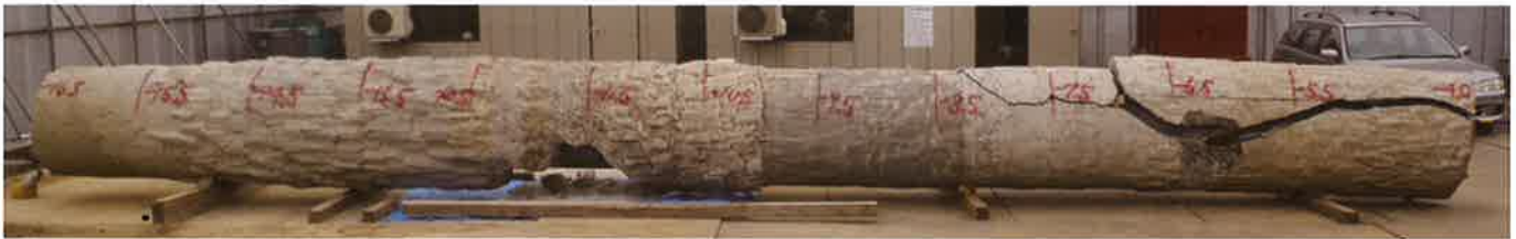
掘出した杭の全景
