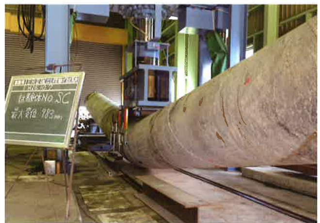
掘出した杭による曲げ試験
